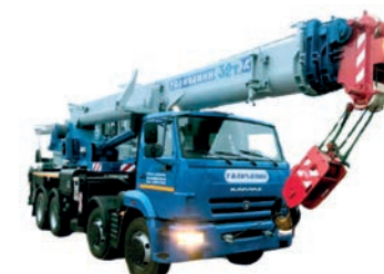
Кран автомобильный стреловой грузоподъёмностью 32 т
