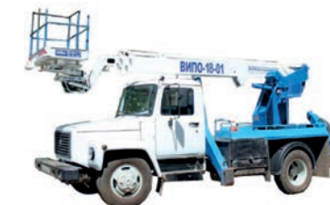
Автогидроподъёмник на базе шасси ГАЗ. Высота подъёма 18 м
