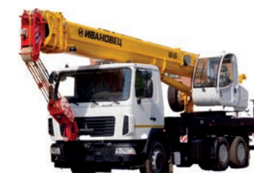
Кран автомобильный стреловой грузоподъёмностью 16-25 т
