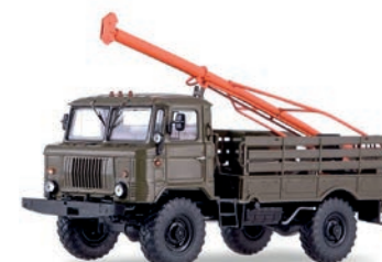
Бурильно-крановая гидравлическая машина на базе автомобиля ГАЗ-66
