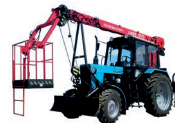
Подъёмник ОПТ 9195 на базе трактора «Беларус». Высота подъёма 7,8 м
