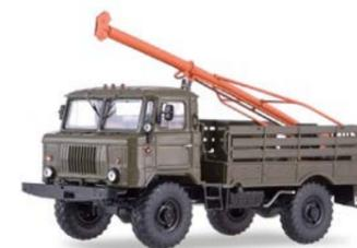
Бурильно-крановая гидравлическая машина на базе автомобиля ГАЗ-66
