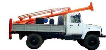
Бурильно-крановая машина на базе автомобиля ГАЗ-33081
