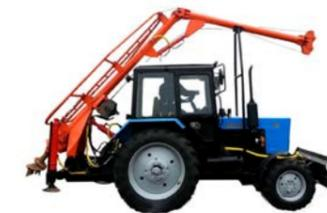
Бурильно-крановая машина на базе трактора «Беларус»
