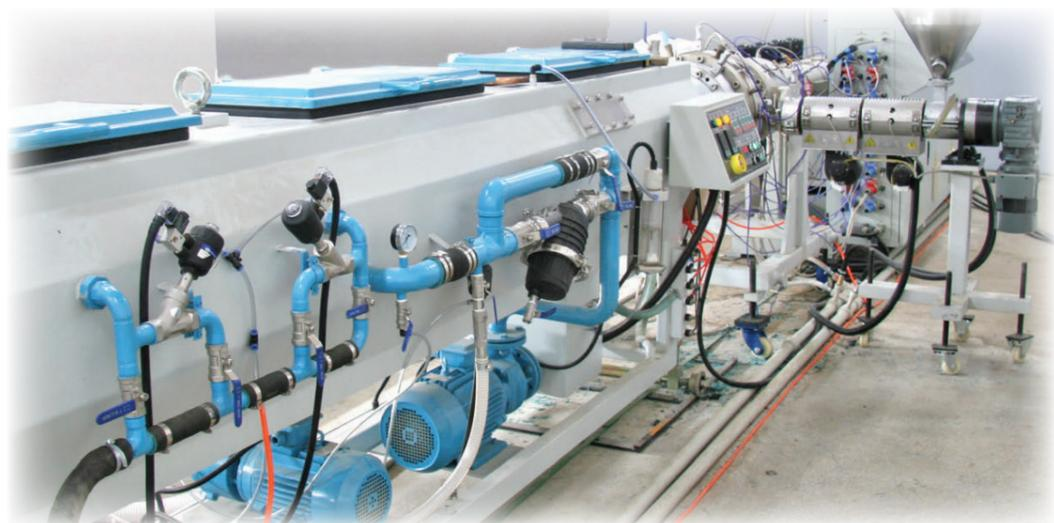
Оборудование позволяет производить трубу как технического, так и питьевого назначения диаметром от 63 мм до 250 мм.
