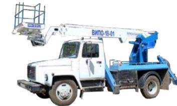
Автогидроподъёмник на базе шасси ГАЗ. Высота подъёма 18 м
