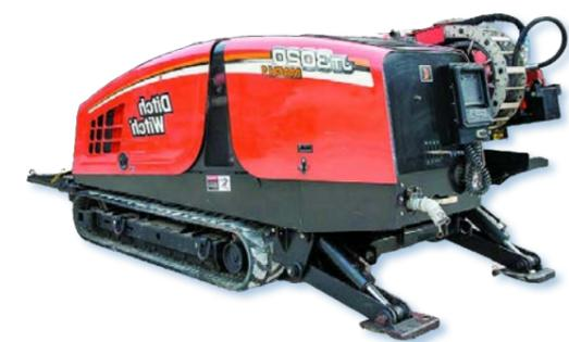
Установка горизонтально-направленного бурения
